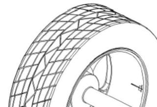
Установка груза на внутренней стороне обода
